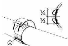
4 – Placer le raccord sur la manchette de façon à ce que les vis de serrage soient positionnées juste au-dessus des plaques C. En refermant le raccord, vérifier qu'il n'y a pas de chevauchement des extrémités de la manchette et que les plaques intérieures sont bien centrées sous les vis de serrage. Se référer au chapitre « Serrage des colliers de raccordement et de réparation » pour terminer l'installation.
