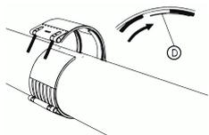
5 – (uniquement dans le cas d'une manchette fixée au boîtier) – Placer le raccord autour du tube et glisser la manchette entre le guide D et le boîtier. Fermer le raccord en engageant les vis sans les serrer puis se référer au chapitre « Serrage des colliers de raccordement et de réparation » pour terminer l'installation.
