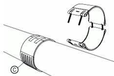
3 – Placer le raccord entre les marques faites précédemment et vérifier que les plaques C servant de fermeture intérieure du collier soient correctement centrées sur la manchette, diamétralement opposées et à 90° de la jonction de la manchette.
