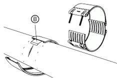
2 – Placer la manchette autour du tube en faisant en sorte que les extrémités ne se recouvrent pas. Aligner les deux parties de la manchette en utilisant le guide B. Ne pas couper la manchette.
