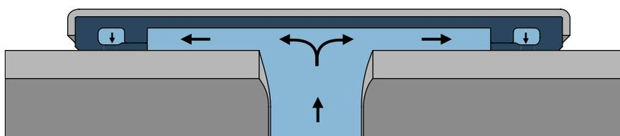
Les colliers de raccordement sont utilisables pour des températures allant de -20°C à +100°C avec joint EPDM ou de -20°C à +80°C avec un joint NBR.
