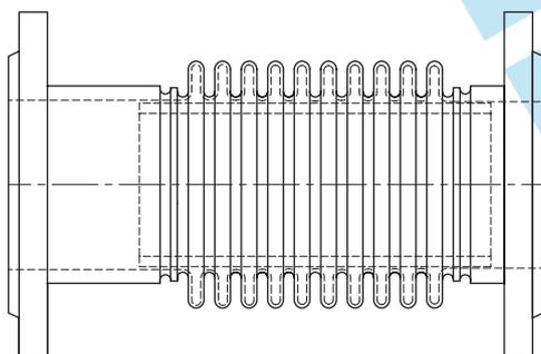
Modèle **58008** A brides fixes avec tube intérieur et capot extérieur
