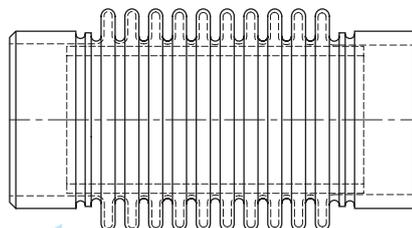
Modèle **58003** A embouts à souder avec tube intérieur et capot extérieur
