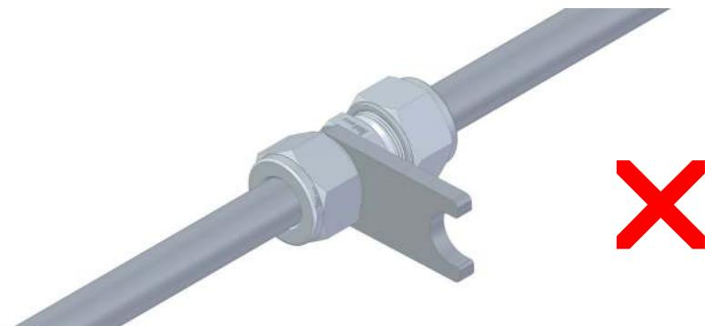
Si la jauge de contrôle passe entre l'écrou et le corps du raccord **le serrage n'est pas suffisant**. Dans ce cas, **resserrer l'écrou** jusqu'à ce que la jauge de contrôle ne passe plus
