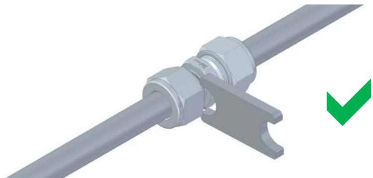
Si la jauge de contrôle ne passe pas entre l'écrou et le corps du raccord **le serrage est parfait**
