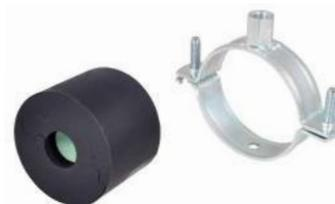
Collier type 72173 avec coquille d'isolation en caoutchouc synthétique avec une feuille de PVC noir et un noyau en mousse PIR à utiliser en combinaison avec des matériaux d'isolation mous ( par exemple, Armaflex®). Lors de l'installation du collier froid, toujours placer horizontalement les zones de contact des coquilles isolantes.
