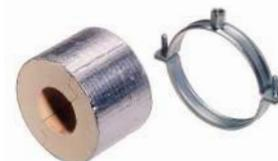
Collier type 72173 avec coquille d'isolation en mousse PIR dure épaisseur 30 mm et feuille d'aluminium renforcée fibres de verre. A utiliser en combinaison avec des matériaux d'isolation durs lors de l'installation du collier froid. Toujours placer horizontalement les zones de contact des coquilles isolantes.
