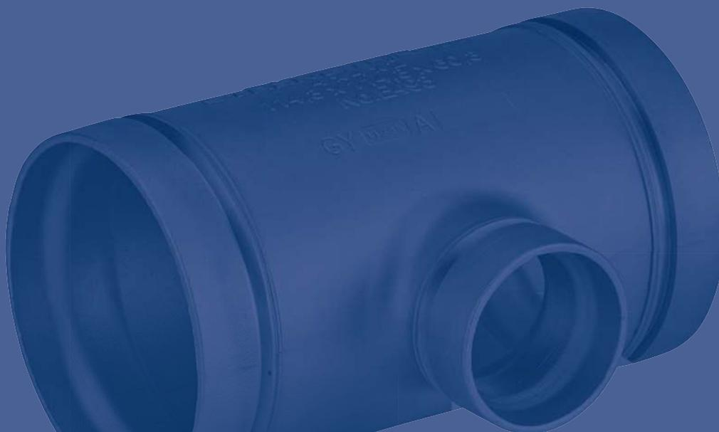
Les raccords rainurés permettent de réaliser des réseaux fluides de façon simple pour des applications basse pression. L'installation de ce système démontable ne nécessite pas de qualification particulière. Les raccords rainurés se montent sur des tubes ISO standards (épaisseur 1,6-3mm) préalablement rainurés.
