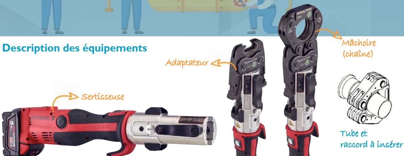
> **Sertisseuse** : machine électrohydraulique fonctionnant sur secteur (modèle 41171) ou sur batterie (modèles 41170, 41172 et 41175) développant l'effort de serrage de 32kN (19kN pour le modèle 41170) nécessaire à la déformation du tube et du raccord qui garantit l'étanchéité de l'assemblage. Le sertissage est radial.
