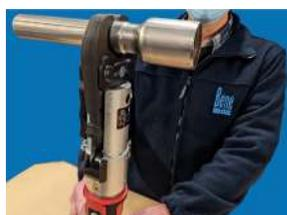
Pour un sertissage compris entre des  $\varnothing$  15 et 35, positionnez sur la machine directement la mâchoire correspondant au diamètre. Pour les  $\varnothing$  42 et plus, équipez d'abord la sertisseuse de l'adaptateur, installez la mâchoire sur le raccord puis ouvrez l'adaptateur pour le positionner sur la mâchoire. Lorsque les éléments sont bien positionnés, démarrez le sertissage.
