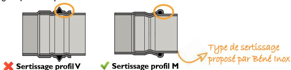
Les raccords à sertir inox sont utilisables jusqu'à une pression maximale de service de 16 bar (10 bar avec la sertisseuse compacte modèle 41170) et une dépression maximale de -0,95 bar pour des températures allant de -20°C à +120°C (avec joints EPDM montés en standard).
