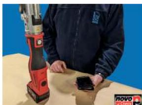
L'application Novocheck permet de se connecter à la sertisseuse Novopress afin de vérifier combien de cycles de sertissage conformes ont été réalisés. En cas de problème avec la sertisseuse, l'application dispose également d'une fonction détection des anomalies qui permet de poser un premier diagnostic. Retrouvez la notice d'utilisation sur le site internet
