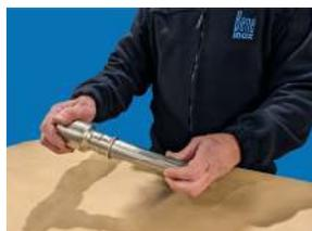
L'extrémité du tube doit être enfoncée dans le raccord en poussant axialement et avec une légère rotation. Ne pas enfoncer le tube obliquement au risque de déplacer ou d'endommager le joint. Pour favoriser l'emboîtement, le joint peut être lubrifié à l'eau pure ou savonneuse. L'usage d'huile ou de graisse comme lubrifiant est interdit avec les joints EPDM.
