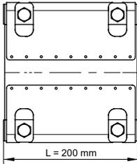
Joint EPDM - Agrément ACS Température : -20°C à +100°C
