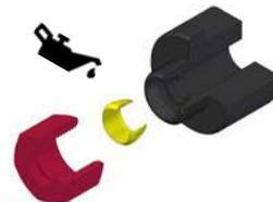
2. Placer le bloc de pré-sertissage dans un étau en veillant à avoir sélectionné le diamètre adapté à celui du tube
