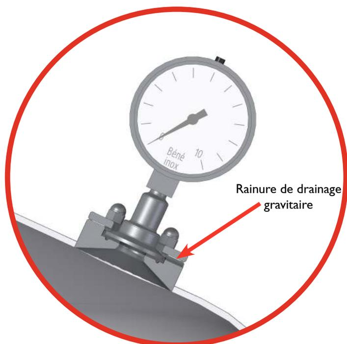
Afin de permettre l'écoulement de liquide dans un environnement humide, la bride arasante comporte un rainure de drainage qui empêche le liquide de stagner.
