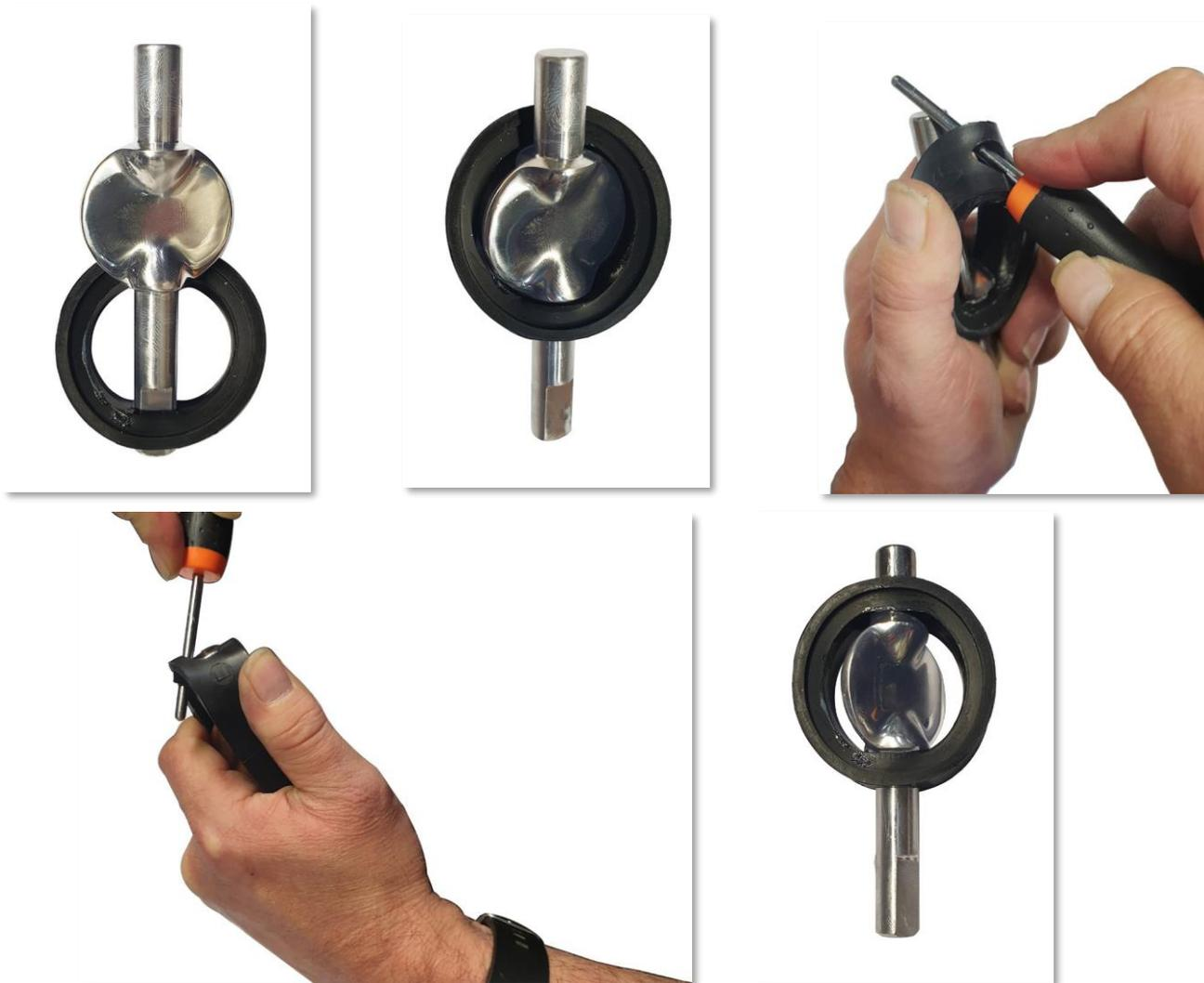
A partir du DN63, le joint peut être déformé manuellement sans outil.
