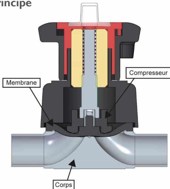
La vanne à membrane se compose globalement d'un corps en inox 1, d'une membrane 2 et d'un actionneur 3 comportant un compresseur.
