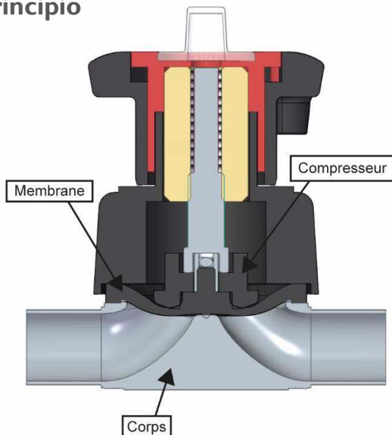
La válvula de diafragma se compone, globalmente, de un cuerpo de inox 1, una membrana 2 y un actuador 3 que incluye un compresor.
