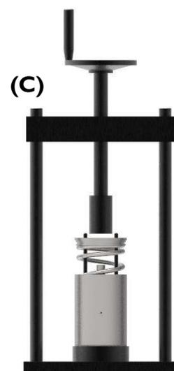
Una vez la alineación esté correctamente realizada, puede apretarse progresivamente la prensa comprobando la correcta alineación del conjunto para no cortar las juntas.
